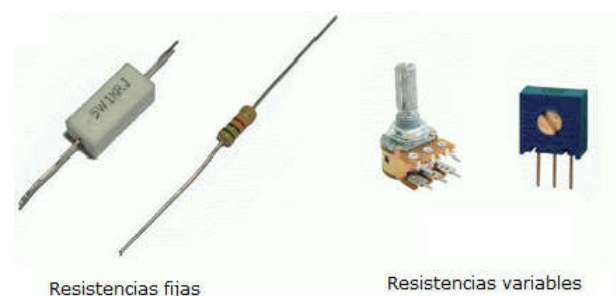
Fig. 1.18. Resistores fijos y variables
