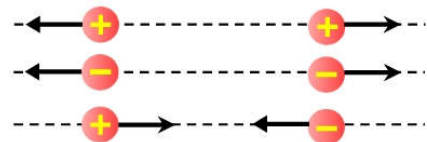
Fig. 1.3. Interacciones entre cargas eléctricas
