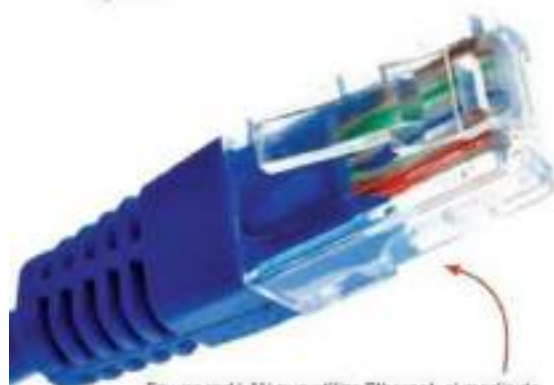
En una red LAN que utiliza Ethernet, el medio de transporte más común suele ser el par trenzado.
